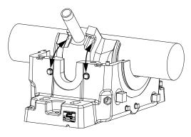
Figure 7 - Align Thermocouple/RTD Holes
