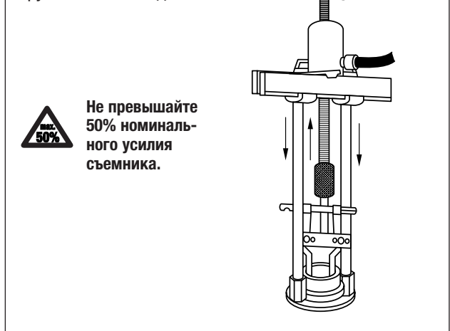
Рис. 4. Съемник-хому́т с насадкой для демонтажа наружных обойм подшипников
