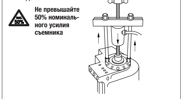
Рис. 5. Работа съемника-хому́та в режиме тянущего действия
