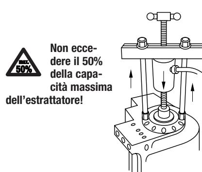
Illustrazione 5 - Calettare con estrattore a tiranti
