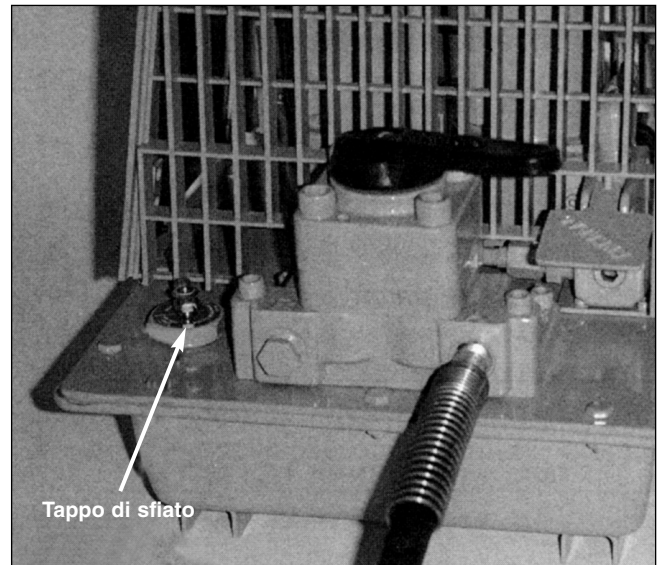
Figura 2 - Posizione del tappo di sfiato/riempimento del serbatoio
