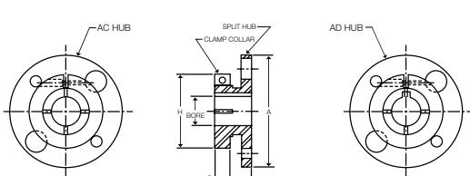
**AL LOCK ELEMENT HUBS** - THESE HUBS USE RINGFEDER TAPERED LOCKING ELEMENTS - MATERIAL CLASS A OR B ONLY
